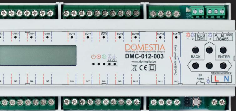
Ces 2 modules permettent de gérer des fonctions diverses (éclairage, volets, prises, ...) via un bus de commande unique ainsi que des scénarios et des groupes.
