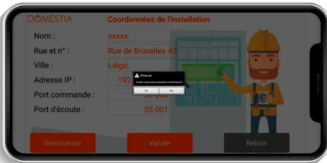
Si la connexion est possible avec la DME-LAN-002 (tablette/ordinateur/smartphone et DME-LAN-002 interconnectés via réseau et paramètres IP compatibles), vous aurez accès à la composition de l'installation.
