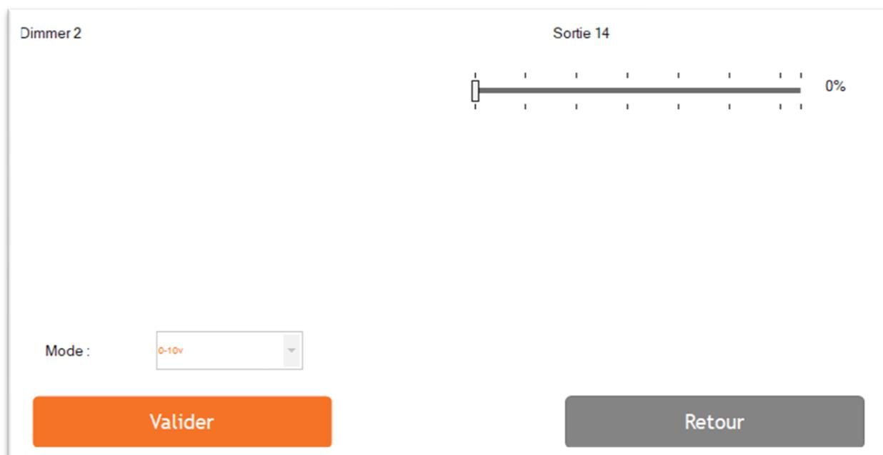
Sélectionner le mode de fonctionnement : 0-10V ou 1-10V.
