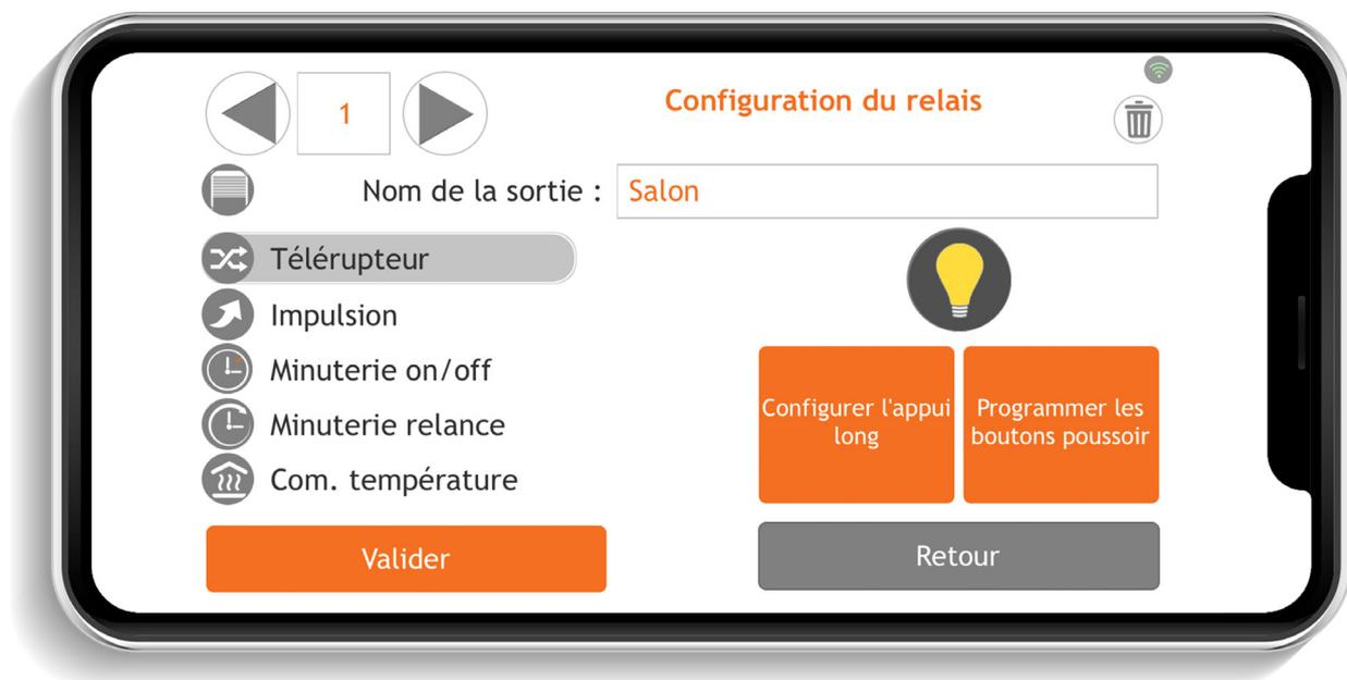
Pour terminer, appuyez à nouveau sur le bouton orange de droite pour sortir du mode programmation ou cliquez sur les flèches du dessus pour sélectionner une autre sortie.
