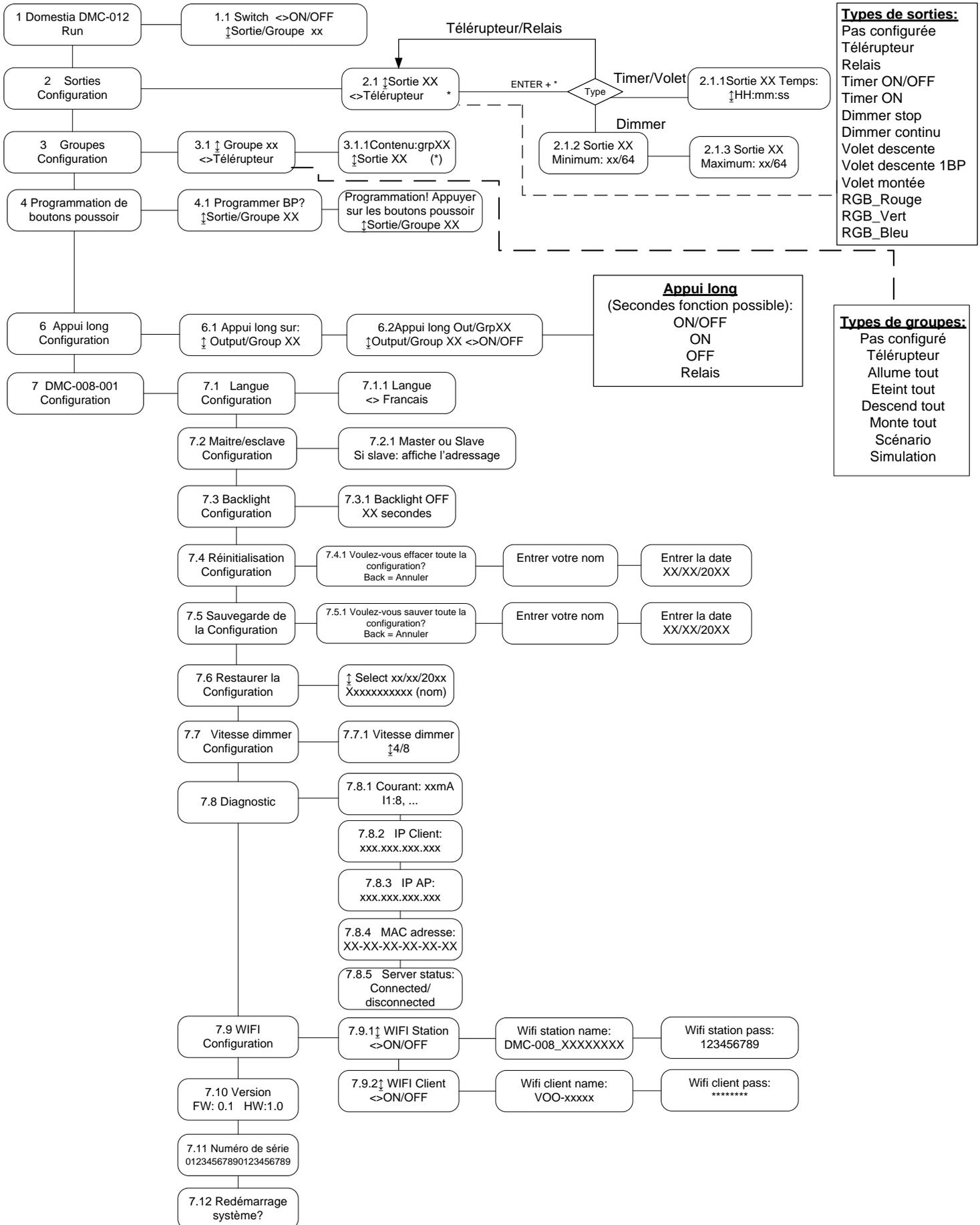
**Le module DMC-012-003 est équipé de 6 boutons pour la programmation avec visualisation via un écran LCD. La navigation dans les menus se fait comme suit :**
