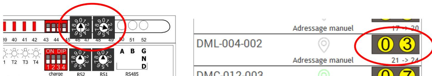
⚠ Les modules DMC-008-001 dont la version logicielle est inférieure à V1.25 doivent être adressé manuellement via les roues codeuses. (La version est visible via le menu 7.10)
