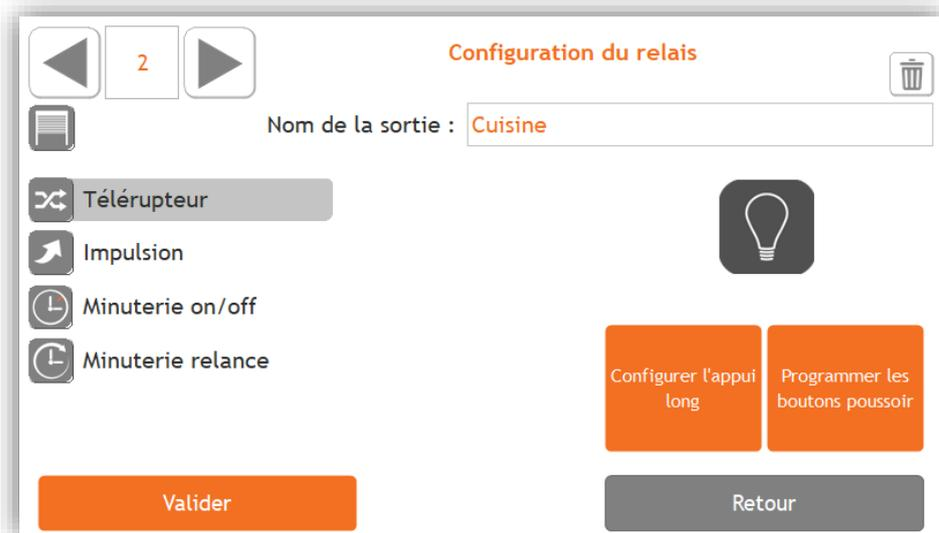
**Les sorties sur un module relais peuvent être configurées en 5 modes différents (cliquez sur le mode désiré) :**
